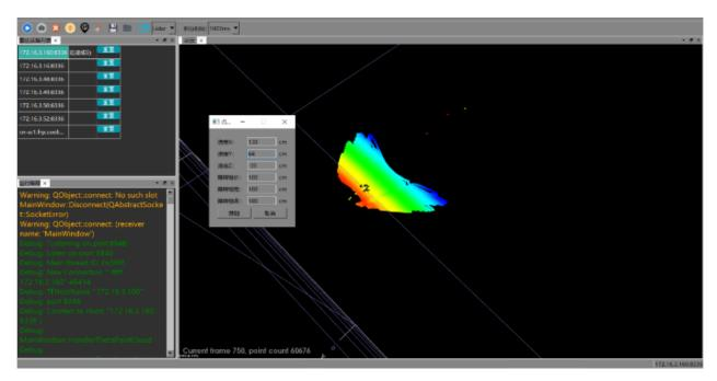
渣土车是城市工程建筑中重要的交通运输工具,经常出现超载、超速等问题,成为城市道路的重大安全隐患之一。我国许多城市尚未实现智能化统一管理,监管难度大,监管人员不足等问题尤为突出。为了从源头解决车辆超载及管理问题,降低由超载导致的交通事故的发生概率。将慧视光电的激光雷达安装于车厢前部,实时检测和识别车厢状态,包括空载满载状态、篷布/铁板密闭状态、车厢举升状态等行为。为统一化管理提供实时的数据支撑,有利于减少城市交通隐患。贵州32线激光雷达结构激光雷达在货车装箱的应用。
